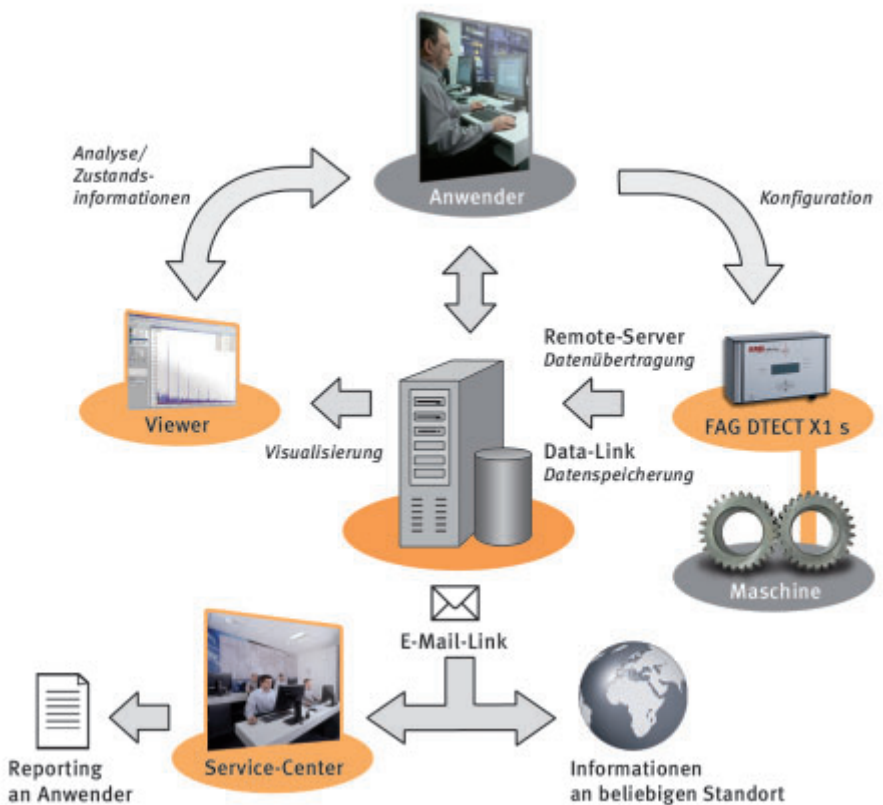
Prozess der Anlagenüberwachung mit dem FAG DTECT X1 s
