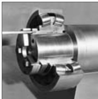
99: Ausbau eines Pendelrollenlagers, das auf einer Abziehhülse sitzt, mit Hilfe des Hydraulikverfahrens
