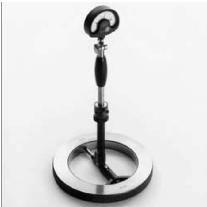
5: Für das Messen von Bohrungen eignen sich besonders Vergleichsmeßgeräte. Der dargestellte Maßring wird zur Einstellung verwendet.
