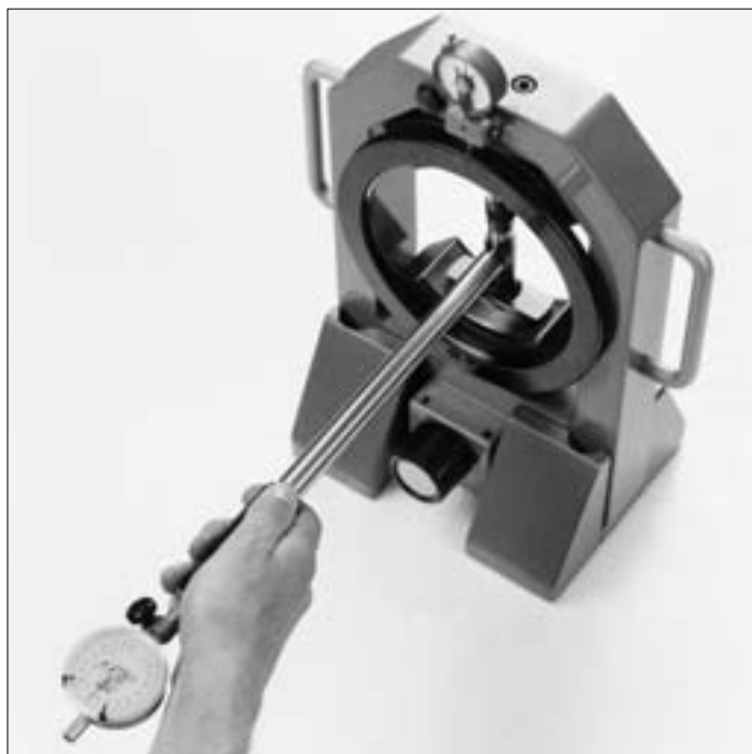
76: Das Maß des Laufbahndurchmessers wird mit dem Bohrungsmeßgerät auf das Hüllkreismessgerät übertragen. Das Hüllkreismessgerät FAG MGA 31 verwendet man bei Zylinderrollenlagern mit abziehbarem Außenring, z.B. FAG NN30ASK.
