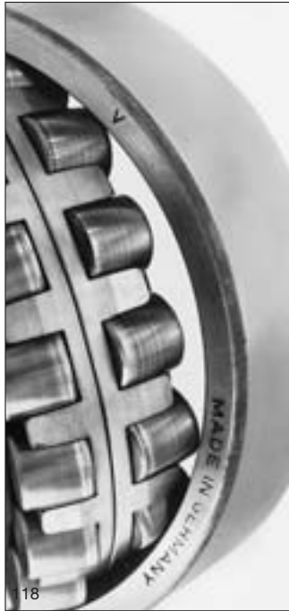
118: Riffelbildung an den Rollen eines Pendelrollenlagers, hervorgerufen durch Stromdurchgang
