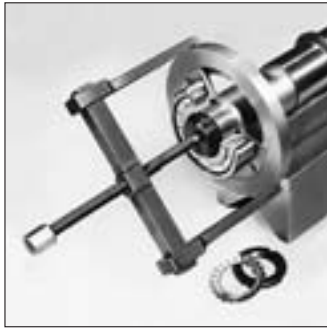
81: Ein Tonnenlager wird mit einer Abziehvorrichtung von der Welle abgezogen
