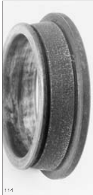
115: Ätzflecken in der Rollbahn eines Pendelrollenlager-Außenrings
