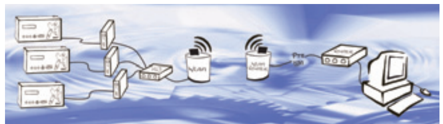
Raccordement de modules DTECT X1 sur un réseau TCP/IP par HUB et routeurs
