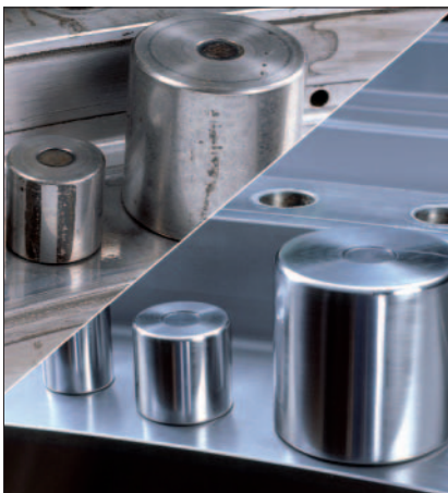
6: Antes: Rodillos con marcas de corrosión e indentaciones de cuerpos extraños Después: Nuevos rodillos con sobremedidas ajustadas
