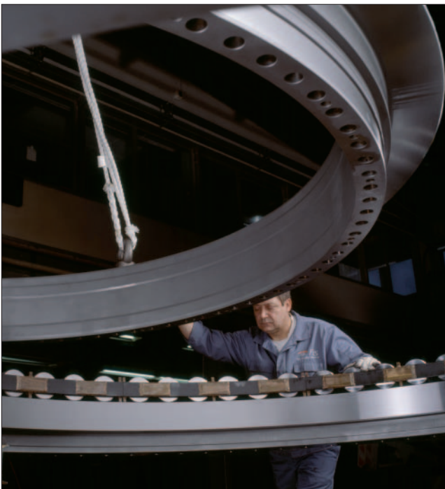
1: Montaje de un rodamiento reacondicionado en una tuneladora
