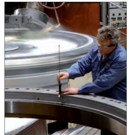
11: Rectificado posterior y control de medidas de un anillo de un gran rodamiento
