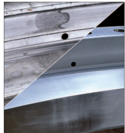
8: Antes: Pista de rodadura con fuerte formación de huellas en la zona de deslizamientos Después: Pista de rodadura rectificada
