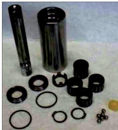
10: Componentes de un rodillo de apoyo para un tren laminador
