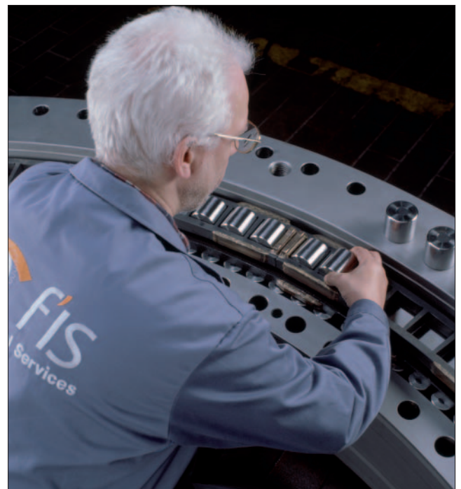
2: Montaje de un rodamiento reacondicionado en una tuneladora
